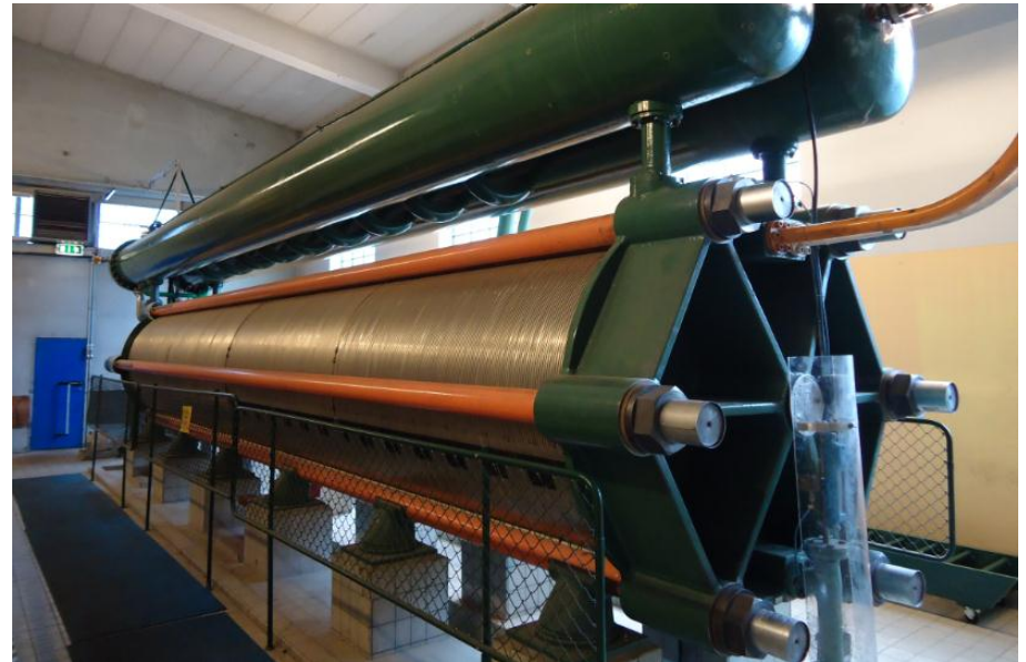
IHT electrolyser – 3.5MW – 760Nm 3 /h H 2
