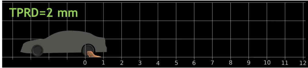
**TPRD=0.5 MM EXCLUDES FORMATION OF FLAMMABLE CLOUD UNDER THE CEILING (NO DEFLAGRATION!)** PLUS TPRD=0.5 MM EXCLUDES DEMOLITION OF GARAGE BY THE PRESSURE PEAKING PHENOMENON
